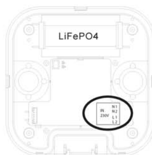
Particolare della morsettiera interna a 4 contatti
