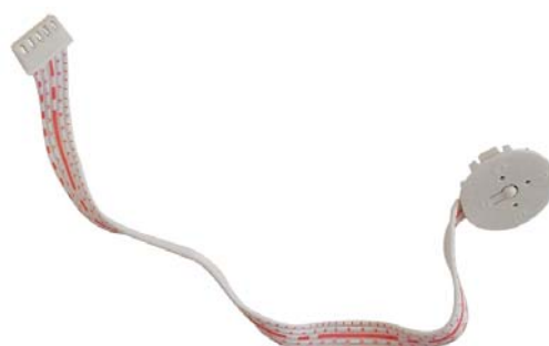
Cavetto con LED indicatori e pulsante di Test
