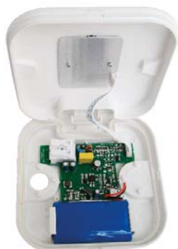
Vista interna della plafoniera
